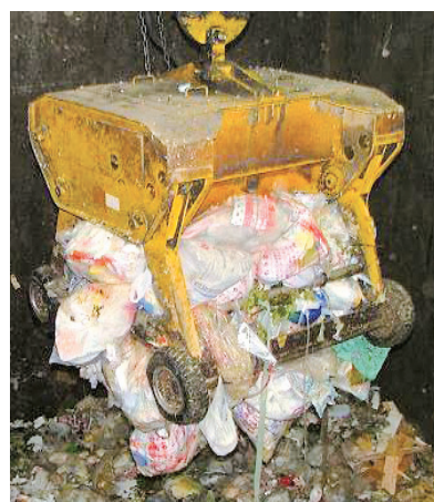
ごみピットとクレーン
